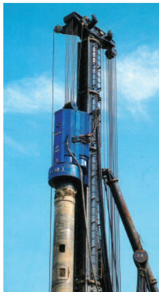
ロックオーガー機 (削孔径φ500~1000mm)
